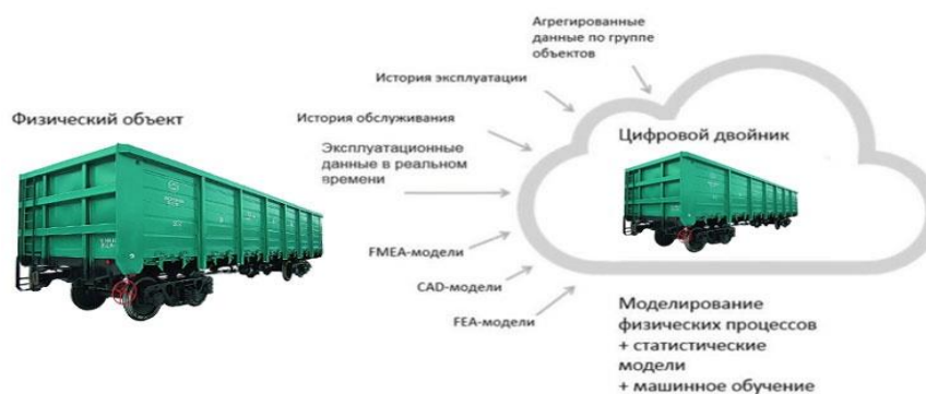
Рисунок 1 – Схема особенностей цифрового двойника вагона
