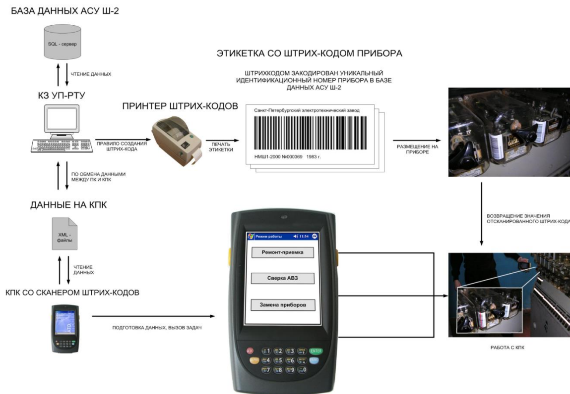
Рисунок 2 – Контроль ремонта и замены приборов, сверка АВЗ с использованием технологии штрих-кодирования
